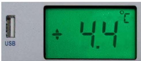
Con possibilità di allarmi di T e di allarme guasto energia, sempre remotizzabili, ed indipendenti da quelli del regolatore principale
