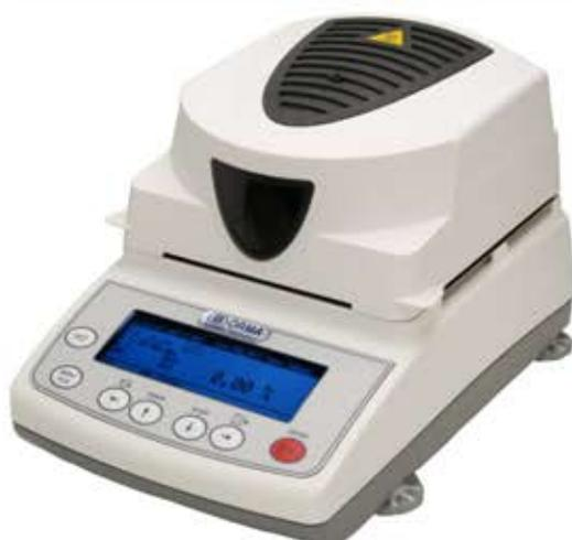
Termobilancia di precisione a lampada Alogena, per la determinazione del contenuto di umidità nei prodotti. Display grafico con peso, residuo secco e umido del prodotto, tempo di essiccazione, peso iniziale, peso finale e temperatura.
